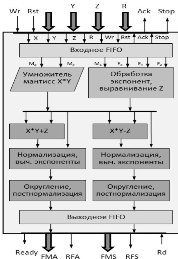
Рис. 3. Структурная схема ядра FMA
