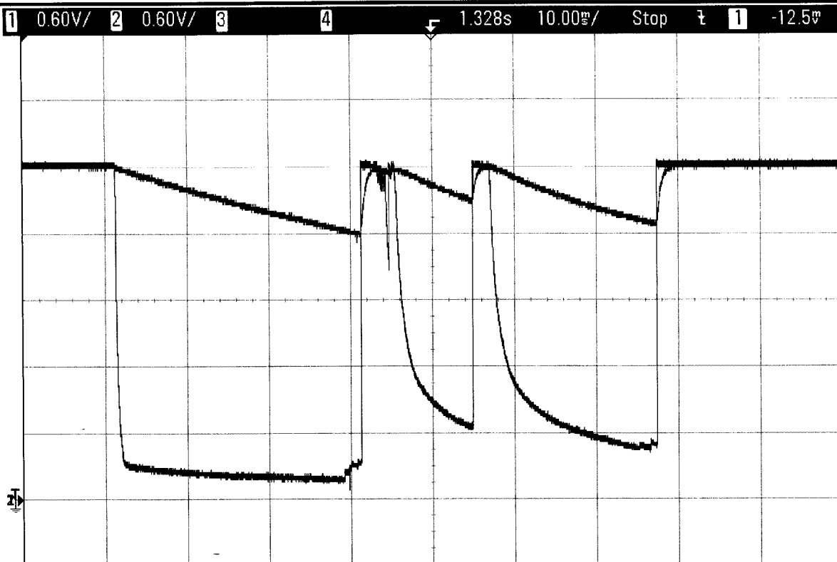
Рисунок Л.5 – Пример осциллограммы напряжений на выводах Vdd и Vdd_C при нарушении питания (черный - Vdd, серый - Vdd_C, C1=10 мкФ, сторожевой таймер отключен)
