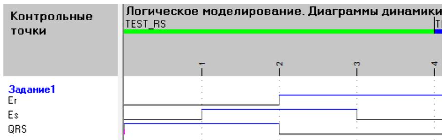
Рис. 3.82. Результат логического моделирования задания 1
