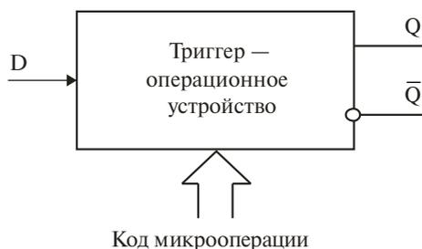
$D$  — однобитовые внешние входные данные (*data*), которые могут быть записаны в триггер для хранения или последующей обработки. Вход  $D$  присутствует только у одного типа триггера ( $D$ -триггер).
