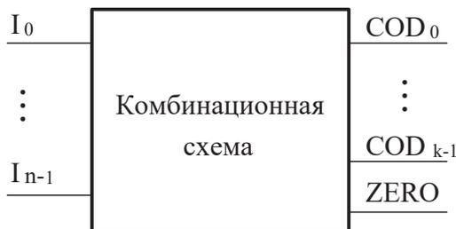
Функциональная схема стробируемого шифратора **COD $n$ kE**
