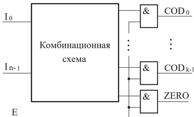
При разработке схем необходимо учитывать, что на выходах нестробируемых шифраторов при изменении входного кода из-за разброса задержек могут возникать функционально необоснованные изменения сигналов (дребезг), что необходимо учитывать при разработке схем.
