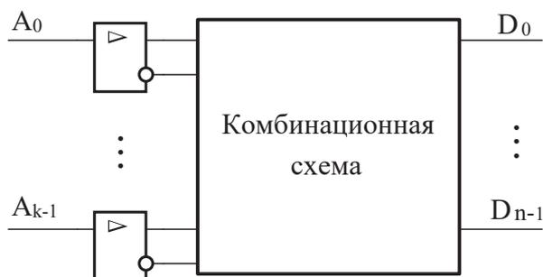
Функциональная схема стробируемого дешифратора  $DCknE$
